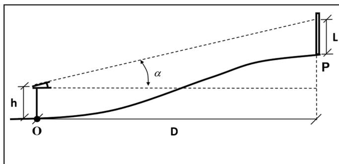
Sabendo-se que  $D=30$  m,  $h=1,4$  m,  $L=1,8$  m e  $\text{tg}(\alpha)=0,25$ , se a cota no ponto O vale 50,0 m, a cota calculada para o ponto P é de:
